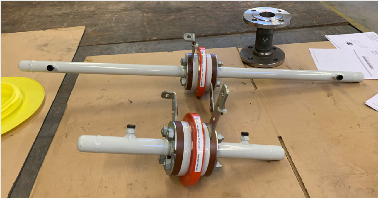
Bild 1: Durch die Verwendung der Isolierflanschverbindungen von der ISOflanges GmbH ist das störungsfreie Funktionieren des Kathodischen Korrosionsschutzes im Rohrleitungs- und Anlagenbau sichergestellt
