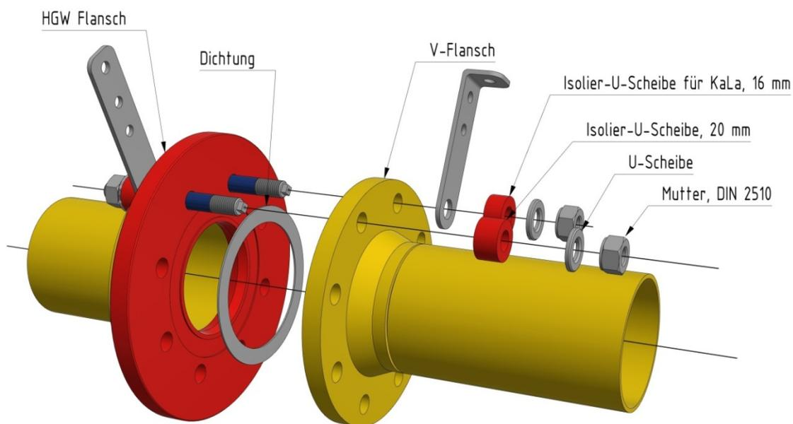
Das anzuwendende Drehmoment ist in der Dokumentationszeichnung der Isolierflanschverbindung angegeben.
